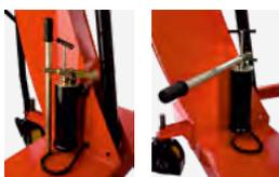
La charge est sécurisée au moyen d'un crochet de sécurité DIN à émerillon en acier zingué et soulevée au moyen de la **pompe de précision Hydrobull à 4 niveaux de force/de réglage de fin de course**. Vous trouverez la description complète sur notre Notice technique 1.
