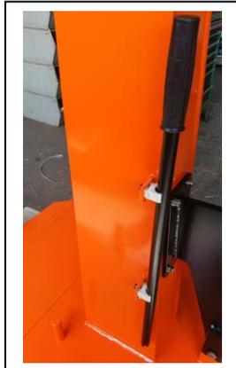
Befestigung Hebel an der Säule
