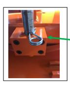
Wird die Sicherung gelöst, kann der Bolzen mit Hilfe des Federsteckers, der dann oberhalb der Halterung eingesteckt wird, in dieser verbleiben und der Kran kann um 360° gedreht werden.
