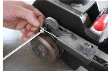
8. Überprüfen Sie dann alle Funktionen und stimmen Sie gegebenenfalls die Befestigungsschraube und die Einstellschraube fein ab und ziehen Sie die Kontermutter an der Einstellschraube fest!
