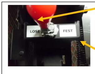
**Stellung Lose:** Der Feststeller ist gelöst, der Kran kann bewegt werden.
