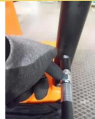
**Sollte es eine Undichtigkeit an der Ölablaßschraube geben, reicht der Austausch dieser Schraube:**
