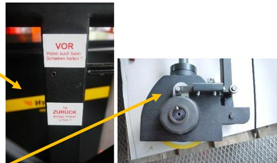
Den Bowdenzug von Feststellschraube (Fapo36) lösen
