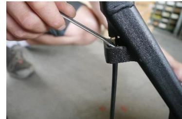
2. Feststellschraube (Pos. 36) lösen
