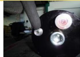
2. Verstellbolzen aus dem Pumpenhebel (4 Bohrungen) entfernen
