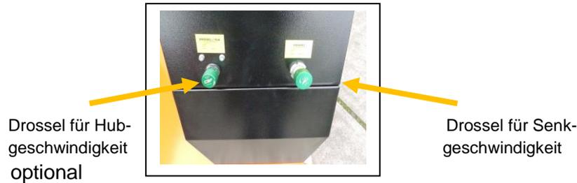
Wenn diese Option bestellt wurde, befindet sich zusätzlich zu dem Drehknopf zur Verstellung der Senkgeschwindigkeit noch ein weiterer grüner Drehknopf am Gerät. Hier ist in einem vorgegebenen Bereich durch Drehung eine Veränderung der Hubgeschwindigkeit erlaubt.
